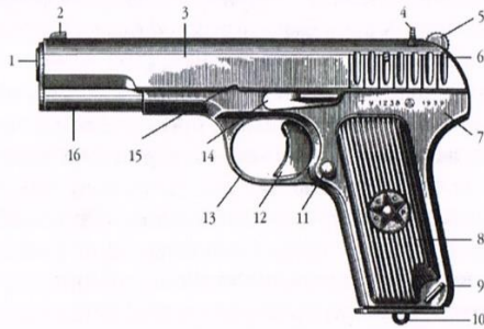
Рис. 1. Элементы конструкции пистолета образца 1930/1933гг. «ТТ»:
